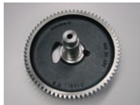
Bild 2: Antriebsrad für einen Bodenverdichter, aus Gründen der Geräuschreduzierung aus ADI (EN-GJS-1000-5)
