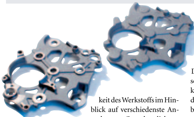
Bild 3: Trägerplatten für 10-Zylinder-Dieselmotoren. Extrem begrenzter Bauraum, hohe Festigkeit, Steifigkeit und Dämpfungseigenschaften erfordern die Herstellung aus ADI-Gusseisen.
