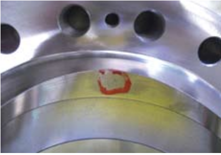
Bild 2: Qualitätsprobleme auf Grund mangelnder Abstimmung zwischen Gieß- und Bearbeitungskonzept: Die Gushaut wurde nicht vollständig entfernt
