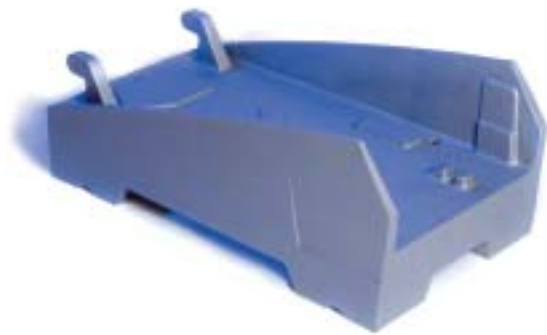
Funktionsintegration als Chance zur Kostenreduzierung: Gegossenes Oberteil für einen Bodenverdichter aus EN-GJL-250 spart zwei separate Gussbauteile und die Verkleidung ein
