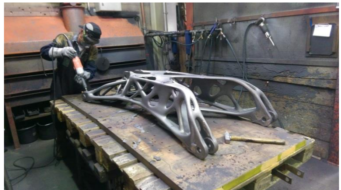
Schleifen und Entgraten des neuen Gussteils aus EN GJS 500-14 ( ca. 200 kg ) bei Procast
