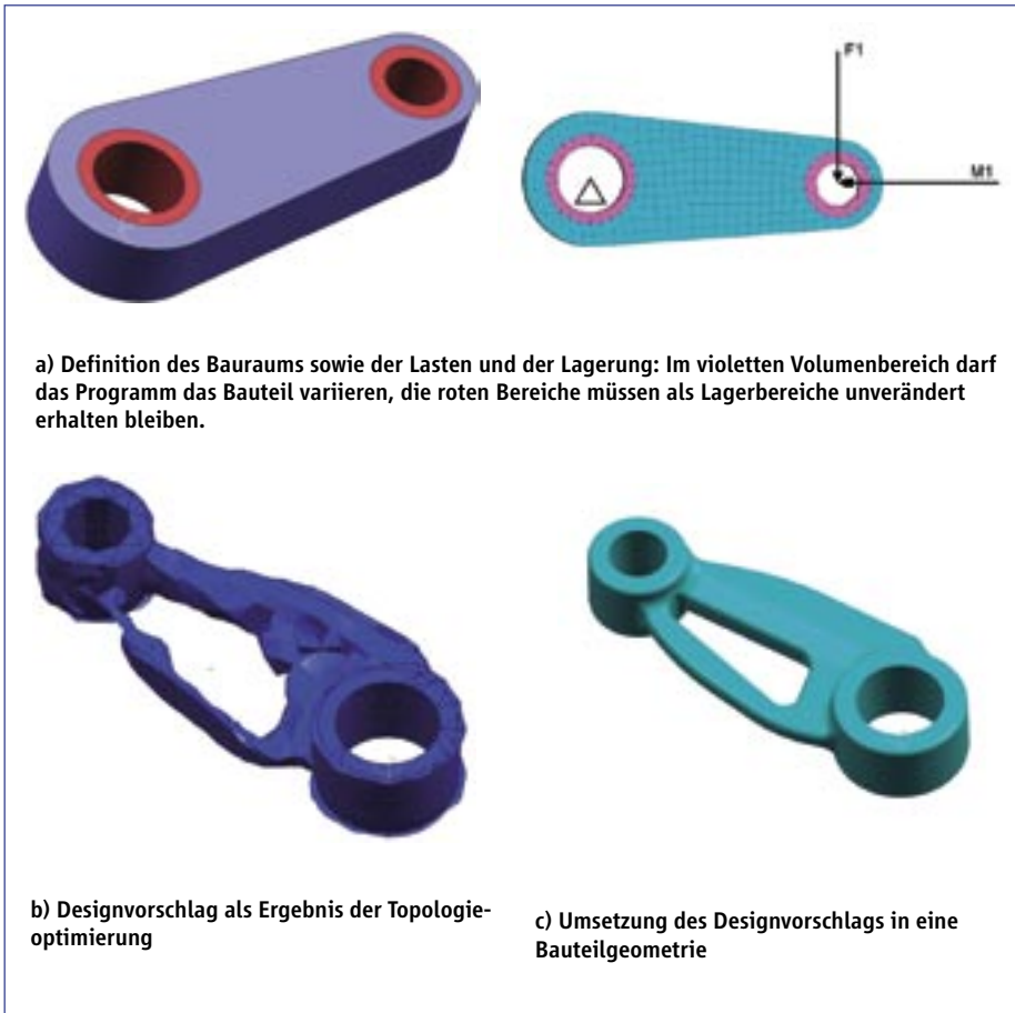
Bild 2: Topologieoptimierung anhand eines einfachen Beispiels, des Teils eines Kurbeltriebs
