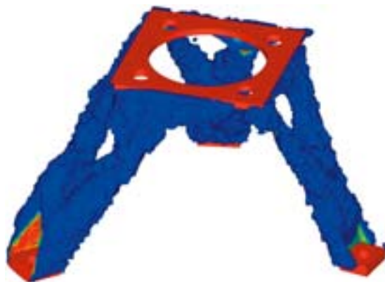
Gewinner des Newcast Award 2007, Kategorie „Beste Substitution eines anderen Fertigungsverfahrens“: Ergebnis der Topologieoptimierung für einen Motorsockel eines Hydraulikmotors (links) sowie das abgeleitete Gussrohsteil aus EN-GJS-400-15 (rechts)
