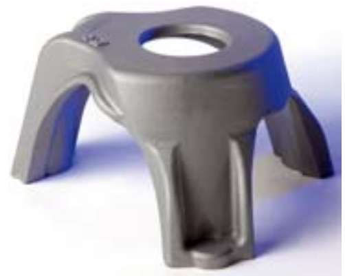
Gewinner des Newcast Award 2007, Kategorie „Beste Substitution eines anderen Fertigungsverfahrens“: Ergebnis der Topologieoptimierung für einen Motorsockel eines Hydraulikmotors (links) sowie das abgeleitete Gussrohsteil aus EN-GJS-400-15 (rechts)
