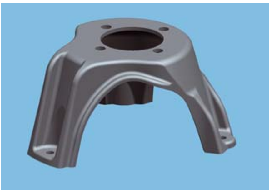
Bild 4: CAD-Modell eines strukturoptimierten Motorsockels
