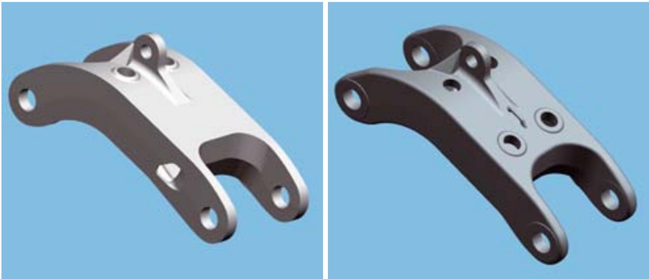
Bild 3: Auf Strukturoptimierung entwickelte Gusskonstruktion eines Wendepfluglenkers/Lenkergeometrie nach Berücksichtigung aller Fertigungsrestriktionen (inkl. Farbgebung)
